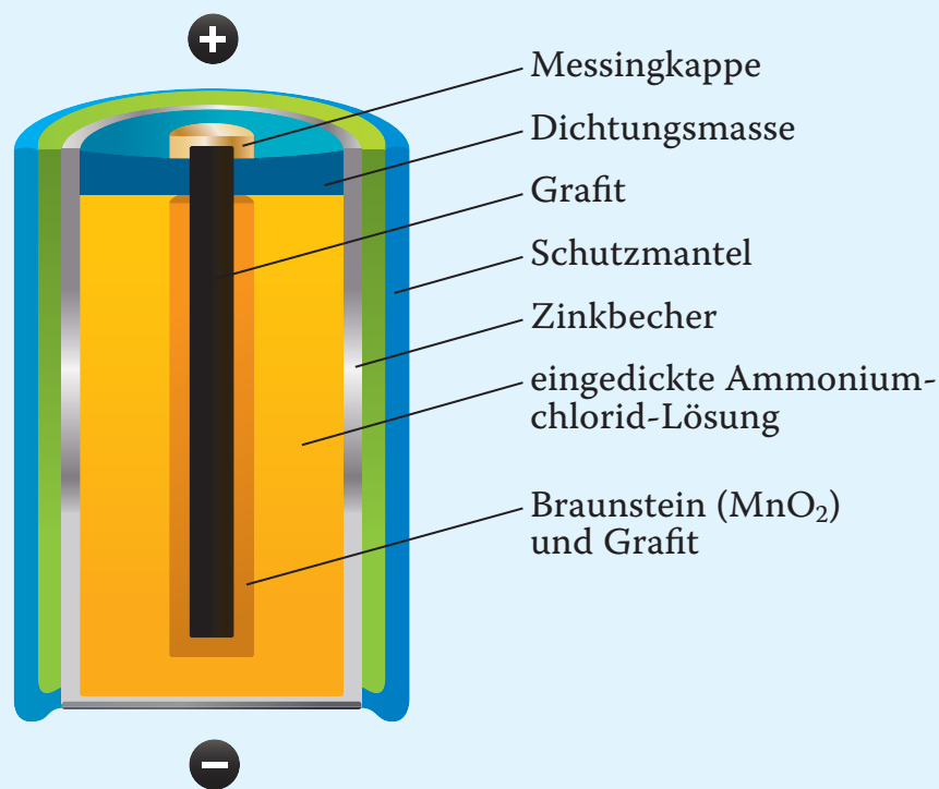
Abb. 23.3 Schematischer Aufbau einer Leclanché-Zelle
