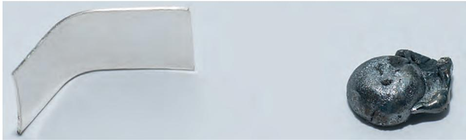
Das Silbersulfid wird nun in einem mit zwei Siliconstopfen verschlossenen Quarzrohr (Abb. 1.11) kräftig mit einem Brenner erhitzt. Nach einiger Zeit beobachtet man fein verteilten gelben Schwefel in der Glasröhre und ein Stück glänzendes Metall, Silber: Das Silbersulfid wurde unter Energieaufwand (Wärmezufuhr) wieder in die Ausgangsstoffe zerlegt.<sup>2</sup>
